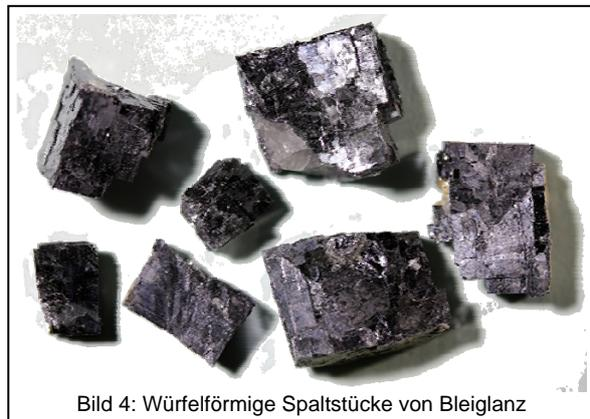
Bild 4: Würfelförmige Spaltstücke von Bleiglanz
